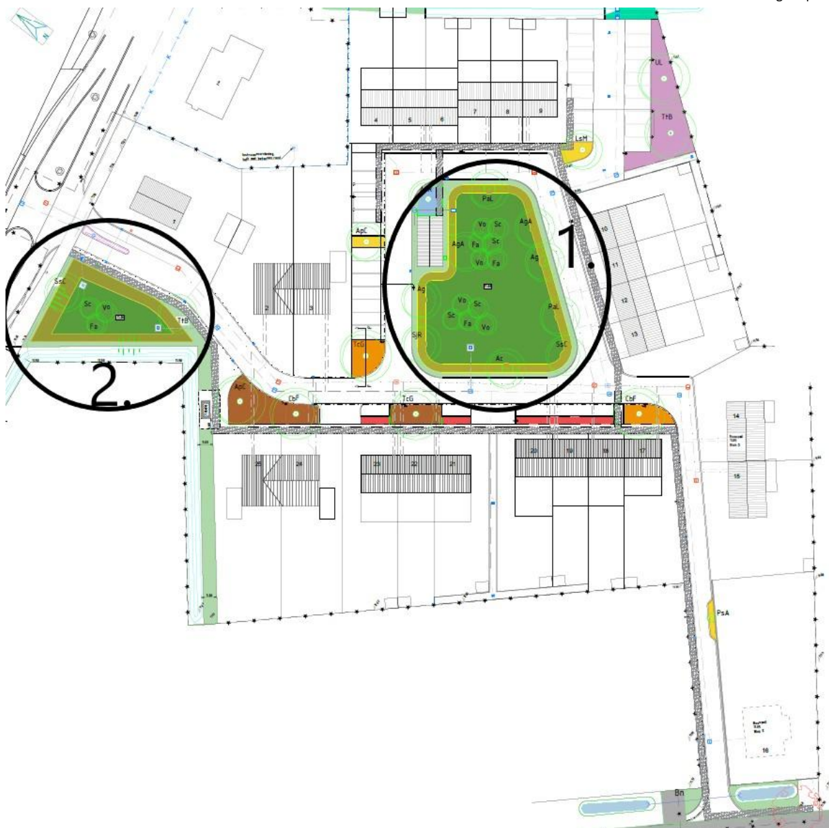
De totale bergingscapaciteit van de 2 WADI's wordt dan 330,3 m 3 . Het systeem voldoet hiermee niet volledig aan de bergingseis van 369 m 3 . Oorzaak hiervan is de geringe diepte van de WADI's, slechts 35 cm. De bodem van de WADI's kunnen niet op een lager niveau omdat het gekozen bodemniveau reeds gelijk is aan de GHG. Het maaiveld verder ophogen is ook geen mogelijkheid a.g.v. de omliggende percelen.
