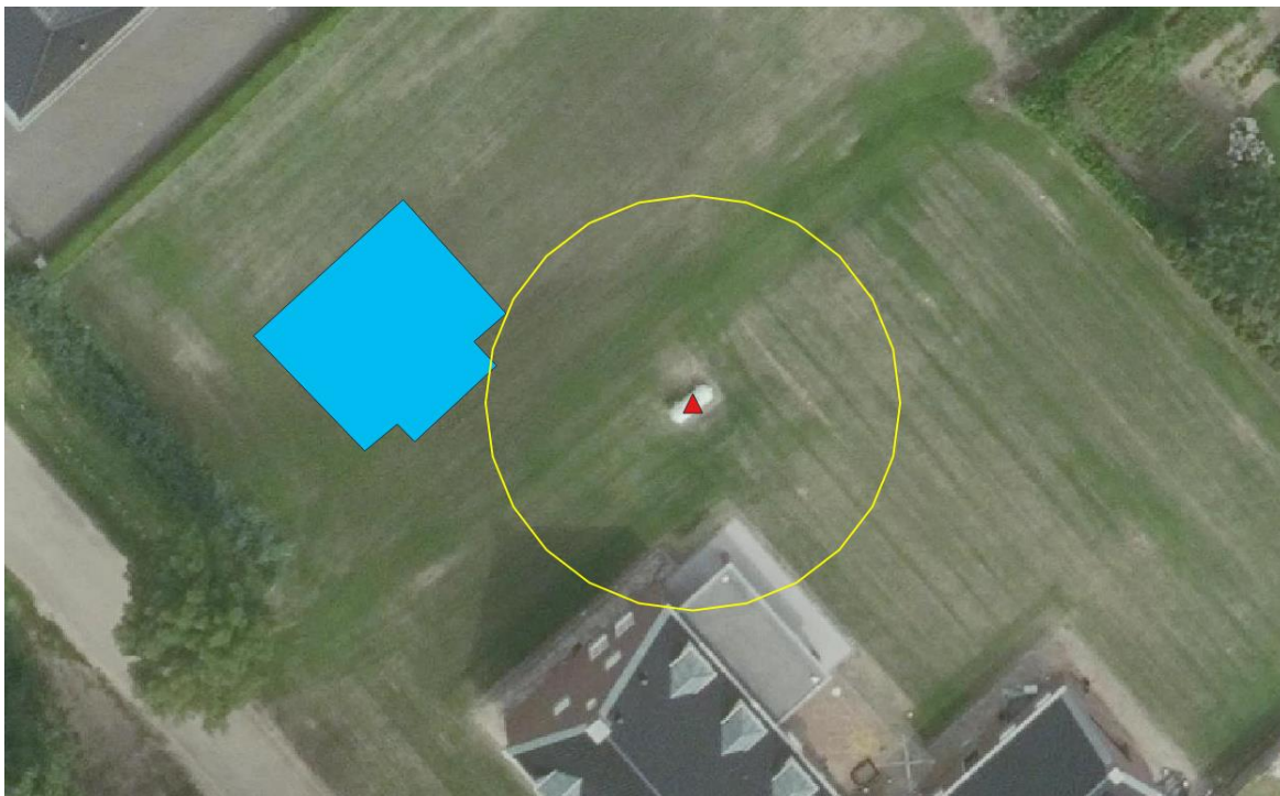
Figuur 3.6 Propaantank met veiligheidsafstand 10 meter.
